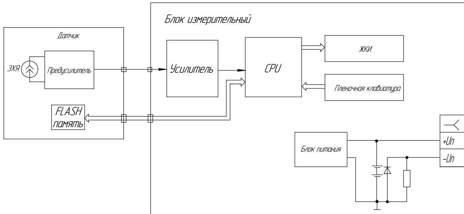
Рисунок 1.3 – Анализатор АНКАТ 7655-04. Схема функциональная
