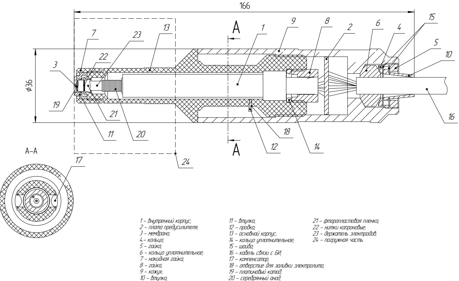
Рисунок 1.2 – Внешний вид и конструкция датчика
