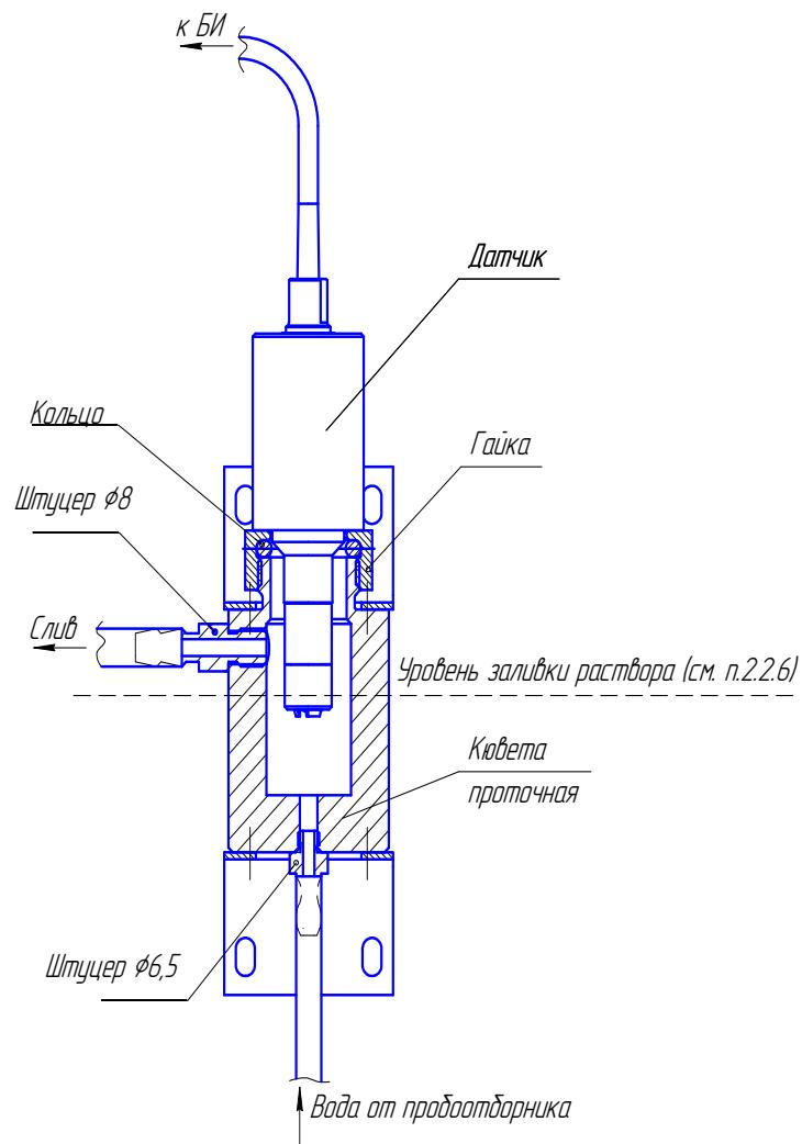
Рисунок 2.1 – Положение датчика в кювете проточной
