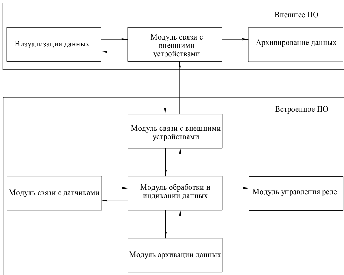
б) для БПС-21М-М Рисунок 4 – Структура ПО
