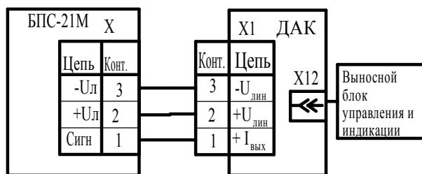
Схема электрическая подключений газоанализаторов
