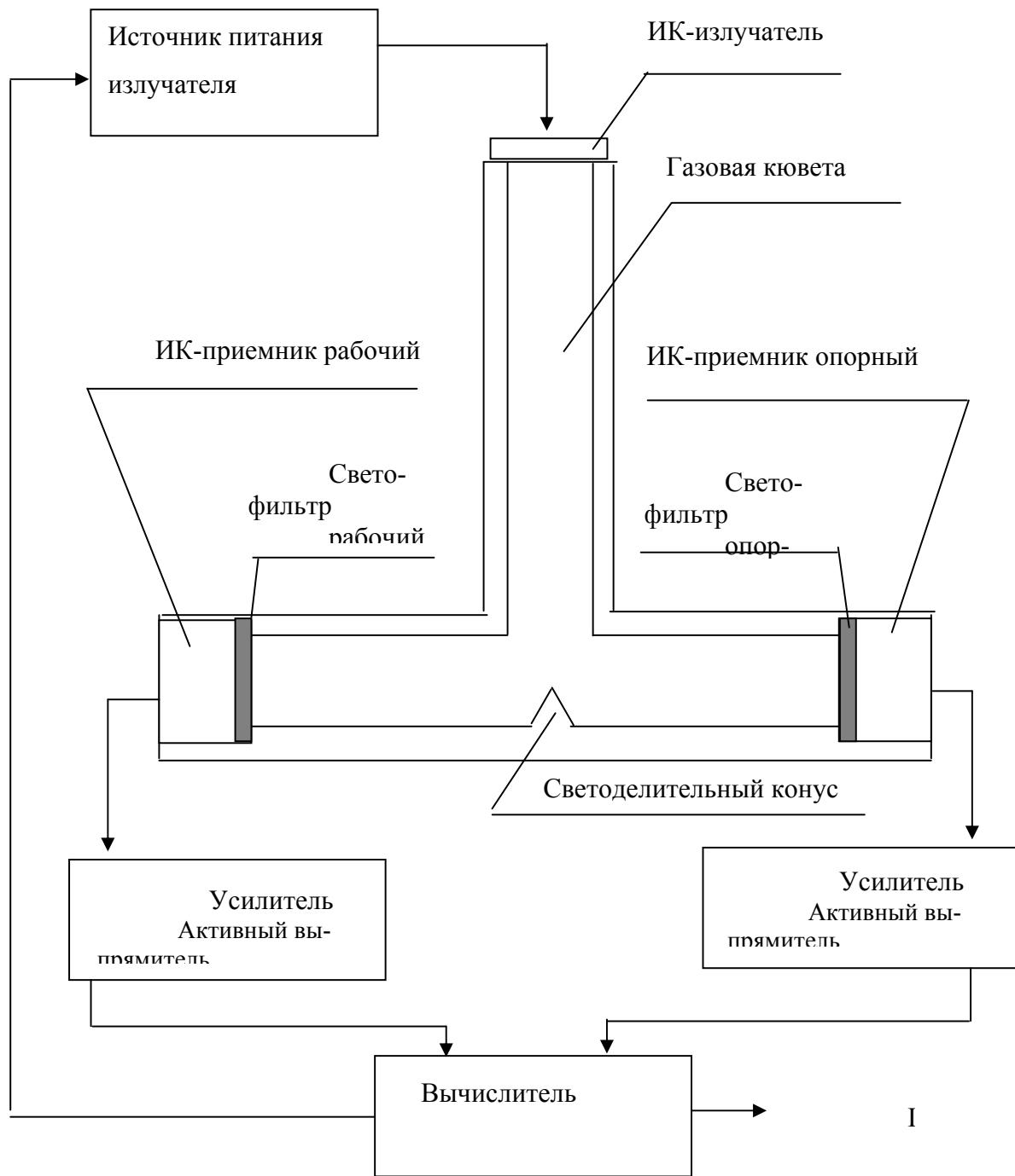
Рисунок 1.2 – Датчики-газоанализаторы ДАК ИБЯЛ.418414.071-06, -07.
