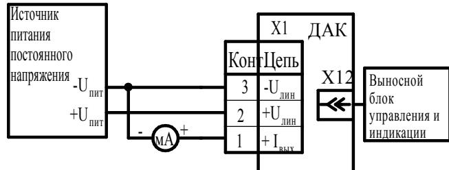
Схема электрическая подключений газоанализаторов
