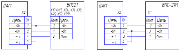
Рисунок 2.1а - Схема электрическая подключений к БПС-21 ИВЯЛ.41111034, (к БПС-21М ИВЯЛ.41111042, выходная колодка (X*) определяется согласно руководству по эксплуатации на БПС-21М)
