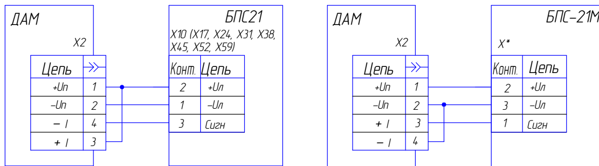
Рисунок 2.1а - Схема электрическая подключений к БПС21 ИБЯЛ.4.11111.034 (к БПС-21М ИБЯЛ.4.11111.042, выходная колодка (X*) определяется согласно руководству по эксплуатации на БПС-21М)
