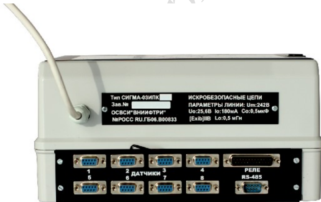
Рис.2.1 Вид задней панели блока информационного СИГМА-03.ИПК 4.4
