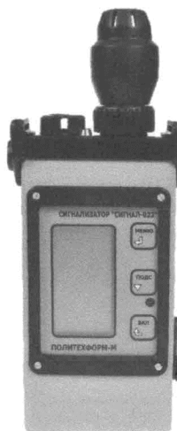
Рисунок 1 - Общий вид сигнализатора "СИГНАЛ-022" с внешним датчиком
