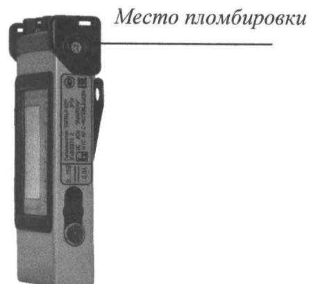
Рисунок 2 - Схема пломбировки от несанкционированного доступа
