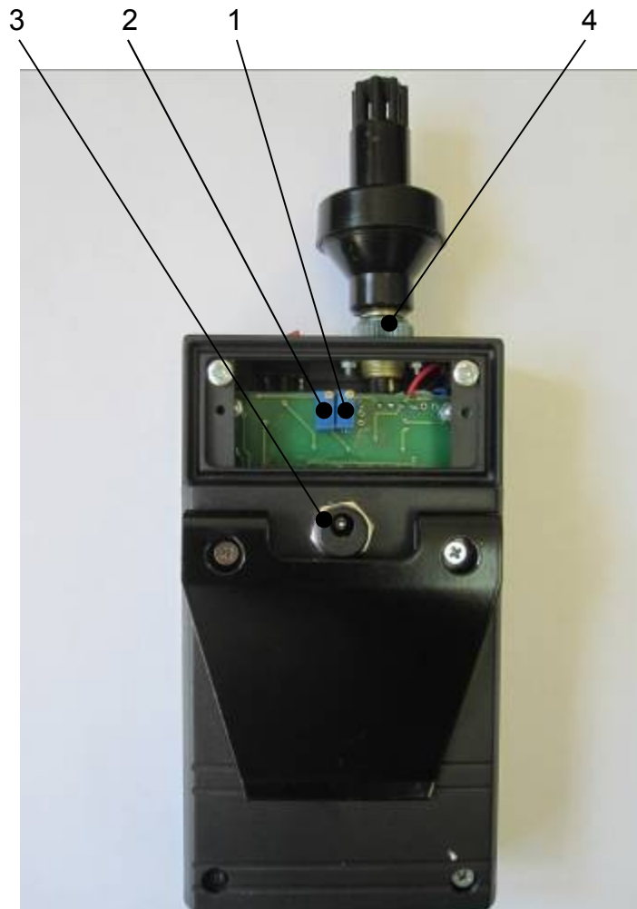
Рис.3. Вид газоанализатора СИГНАЛ-4 сзади со снятой крышкой.
