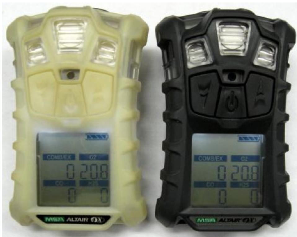
а) - версия с фосфоресцирующим корпусом, б) - версия с обычным корпусом
