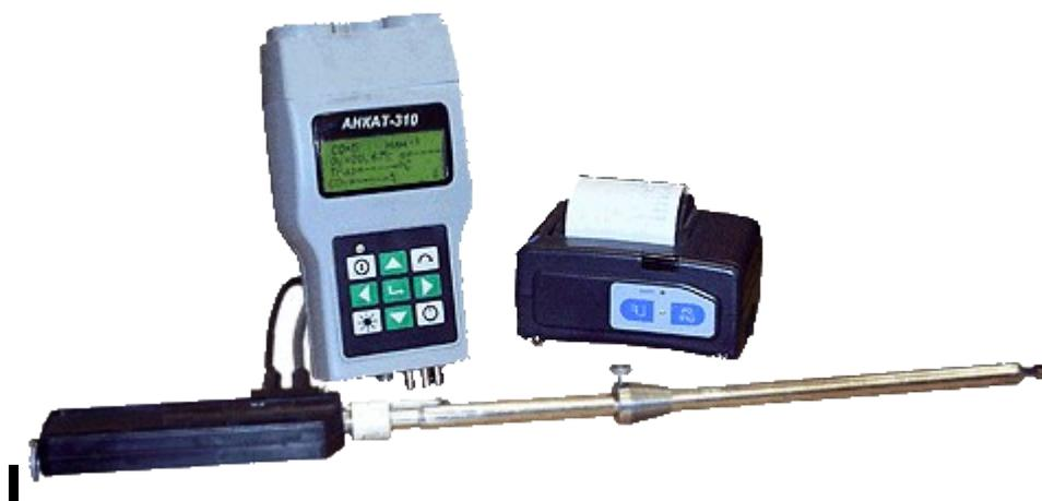
Настоящая методика поверки распространяется на газоанализаторы АНКАТ-310 (в дальнейшем – газоанализаторы) и устанавливает методику первичной (при выпуске из производства, после ремонта) и периодической поверки в процессе эксплуатации.
