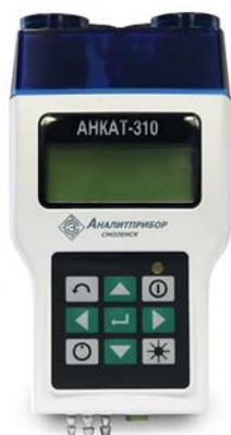
Предназначен для проведения пуско-наладочных работ при эксплуатации топливосжигающих установок с целью оптимизации режимов горения, а также контроля экологически вредных выбросов. Измеряет и вычисляет компонентный состав, температуры и другие параметры дымовых газов.
