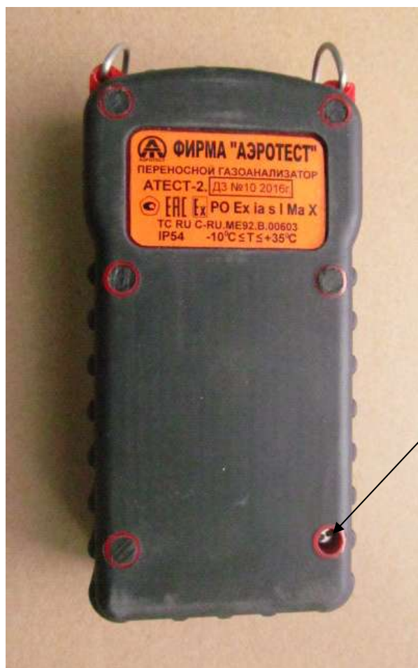
Рисунок 2 - Место пломбирования газоанализатора переносного АТЕСТ-2
