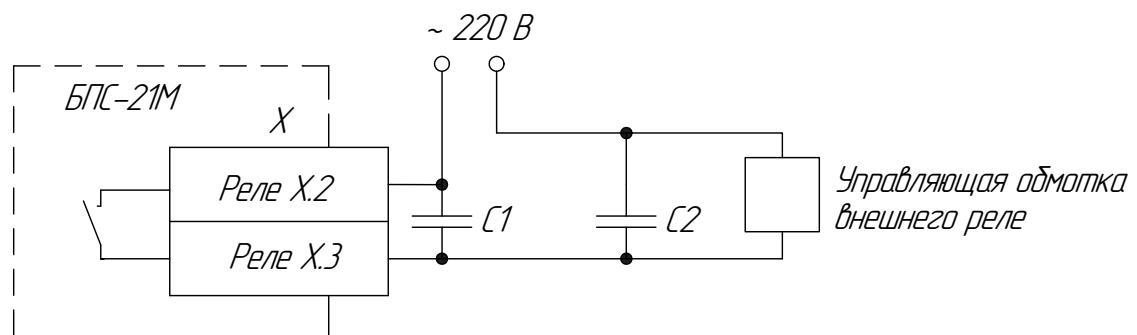
X – контакты реле (СТАТУС, РЕЛЕ1 ... РЕЛЕ8);
