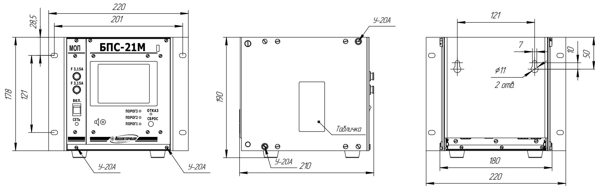
Рисунок 1.1 – Блоки питания и сигнализации БПС-21М-М. Внешний вид
