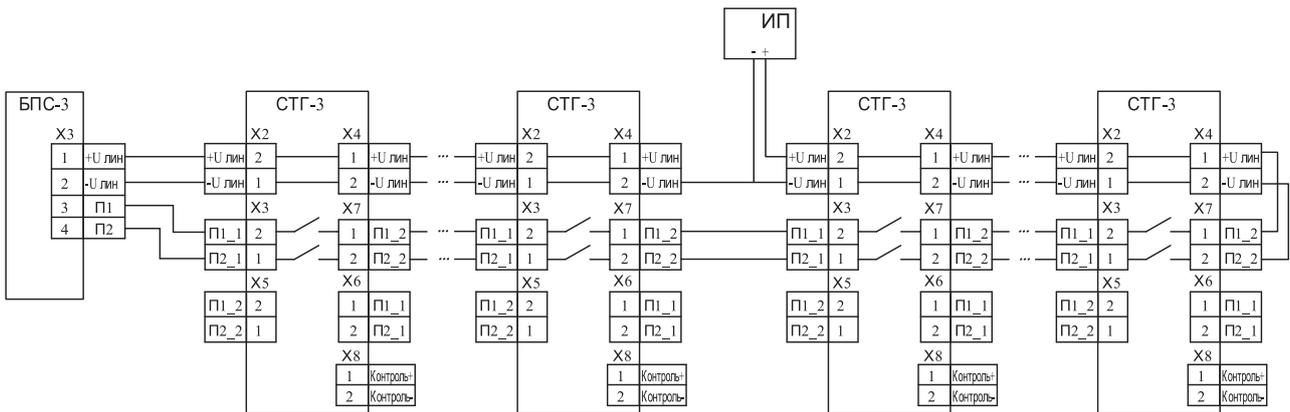
Схема шлейфового подключения сигнализаторов СТГ-3 к блоку БПС-3-И дополнительного источника питания
