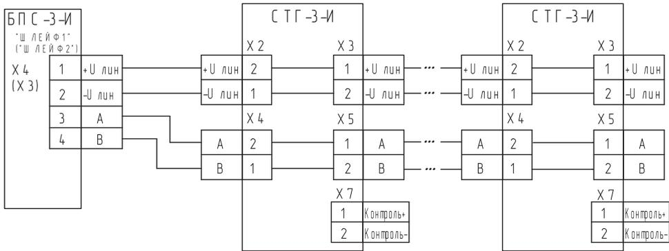
Схема шлейфового подключения сигнализаторов СТГ-3 к блоку БПС-3 и дополнительного источника питания
