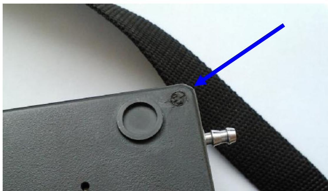
Рисунок 2 - Место нанесения клейма.
