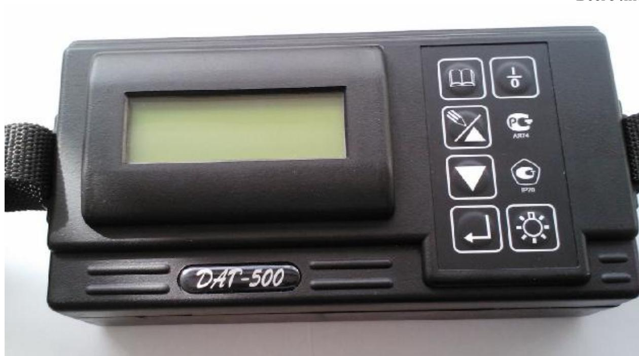
Рисунок 1 - Внешний вид газоанализатора ДАГ-500.
