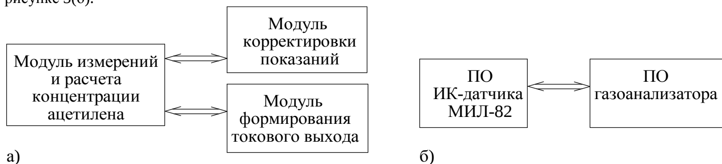
Рисунок 3 – Структура ПО газоанализаторов
