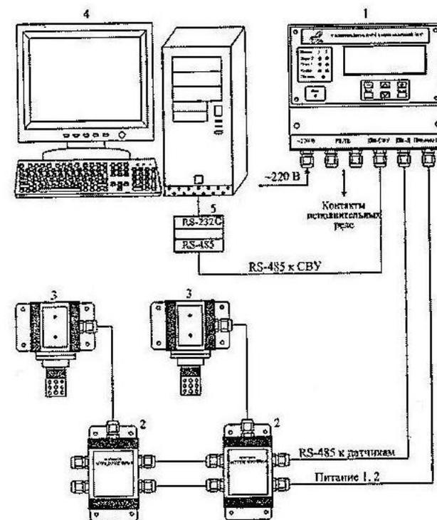
Рисунок 2 – Схемы подключения стационарного газоанализатора ЭГС в составе автоматизированных систем при использовании БУ уменьшенных габаритов.
