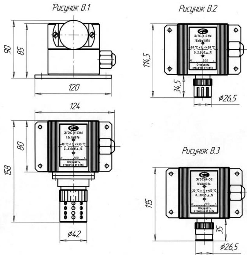
Рисунок В.1- Датчик с сенсором оптическим
