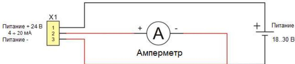
Рис.4. Разъём X1 для, предназначенный для подключения электропитания и вывода токового сигнала
