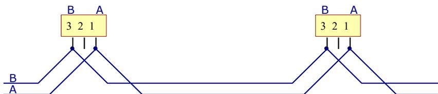
Рис. 6. Соединение газоанализаторов с кабелем витая пара без ответвлений
