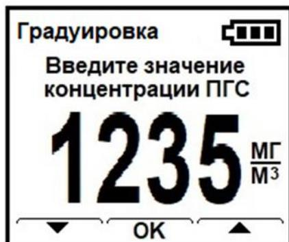
Для изменения значения концентрации используйте кнопки ▼ (уменьшение) и ▲ (увеличение) - для изменения концентрации на единицу следует кратковременно нажать соответствующую кнопку, для быстрого изменения - нажать и удерживать соответствующую кнопку. После установки заданного значения концентрации нажмите кнопку ОК.
