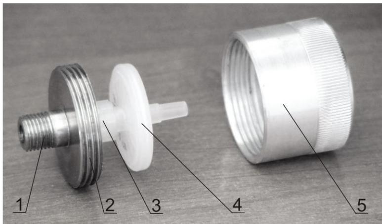
Рис 5. Пробоотборное устройство.
