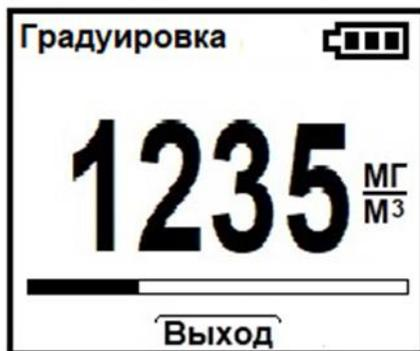
Для отмены установки чувствительности нажмите кнопку ВЫХОД.
