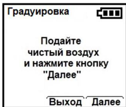
Подайте ПГС-ПНГ воздух на вход ИП согласно п. 3.6.2.1. и нажмите кнопку ДАЛЕЕ, после чего начинается процесс установки нулевого сигнала, дисплей имеет вид
