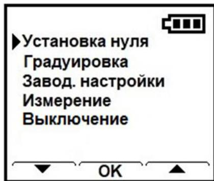
Указание конкретной операции производится с помощью кнопок ▼ и ▲, указатель ► на дисплее перемещается по пунктам меню. Вызов операции производится с помощью кнопки ОК.
