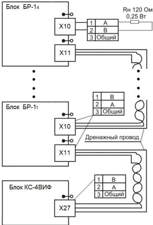
Рис. 14. Схема подключения блоков БР к блоку КС
