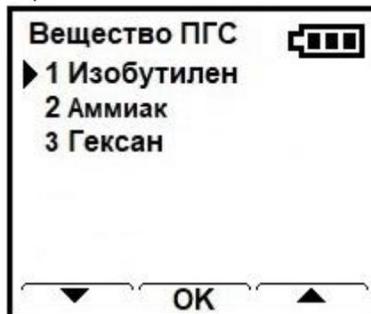
С помощью кнопок ▼ и ▲ указатель ► перемещается по пунктам меню, выбор конкретного вещества ПГС производится с помощью кнопки ОК.
