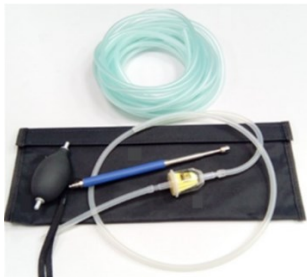
Рисунок 7 - Ручной насос с зондом (см. приложение Г )
