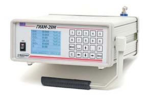
Предназначен для определения содержания оксида углерода, углеводородов, кислорода, оксида азота, диоксида углерода; вычисления значения коэффициента избытка воздуха (только для ГИАМ-29М-4) и объемного содержания суммы оксидов азота (NOx).
