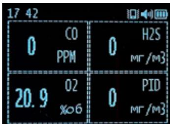
Рисунок 6 – Дисплей HardGas X4 в «основном режиме работы»
