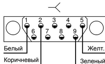
\* Примечание: цвета проводов даны для случая поставки кабеля LIYY 4 x 0.75 с завода-изготовителя
