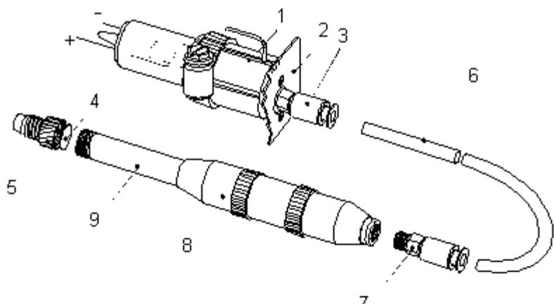
**Рис. 3. Схема соединения элементов пробоотборника с газоанализатором**
