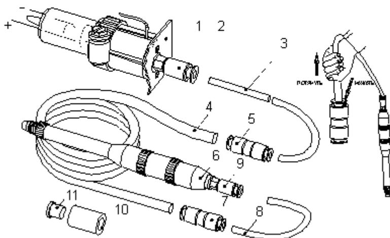
**Рис. 4. Схема соединения элементов удлинителя с газоанализатором**
