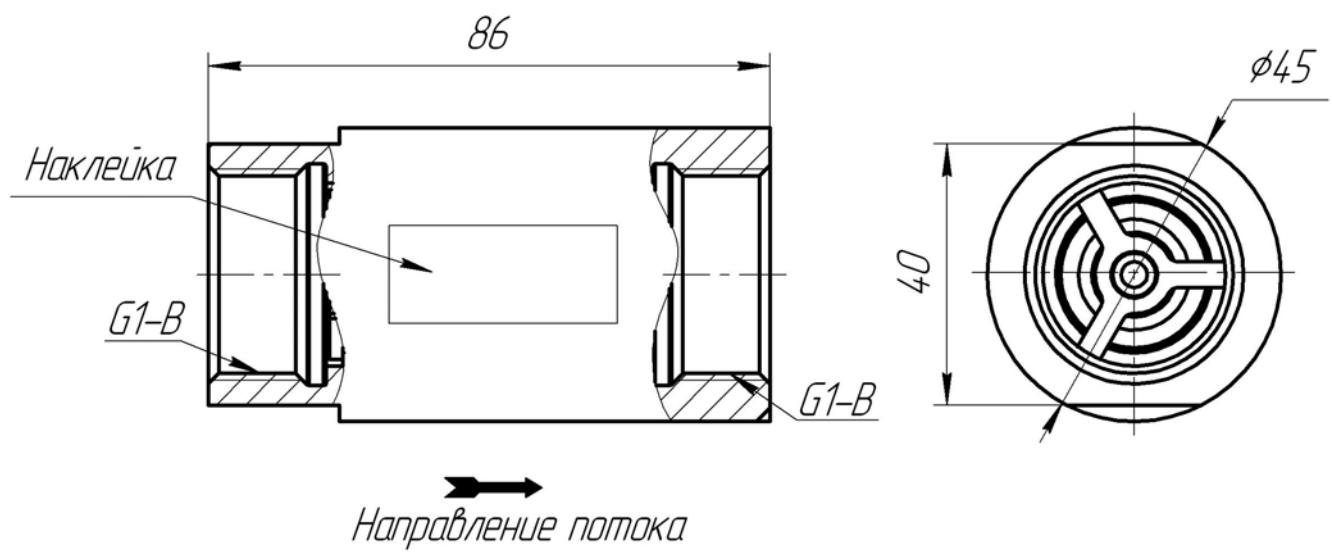
Рисунок 1 – Клапан термозапорный типа DN 25.
