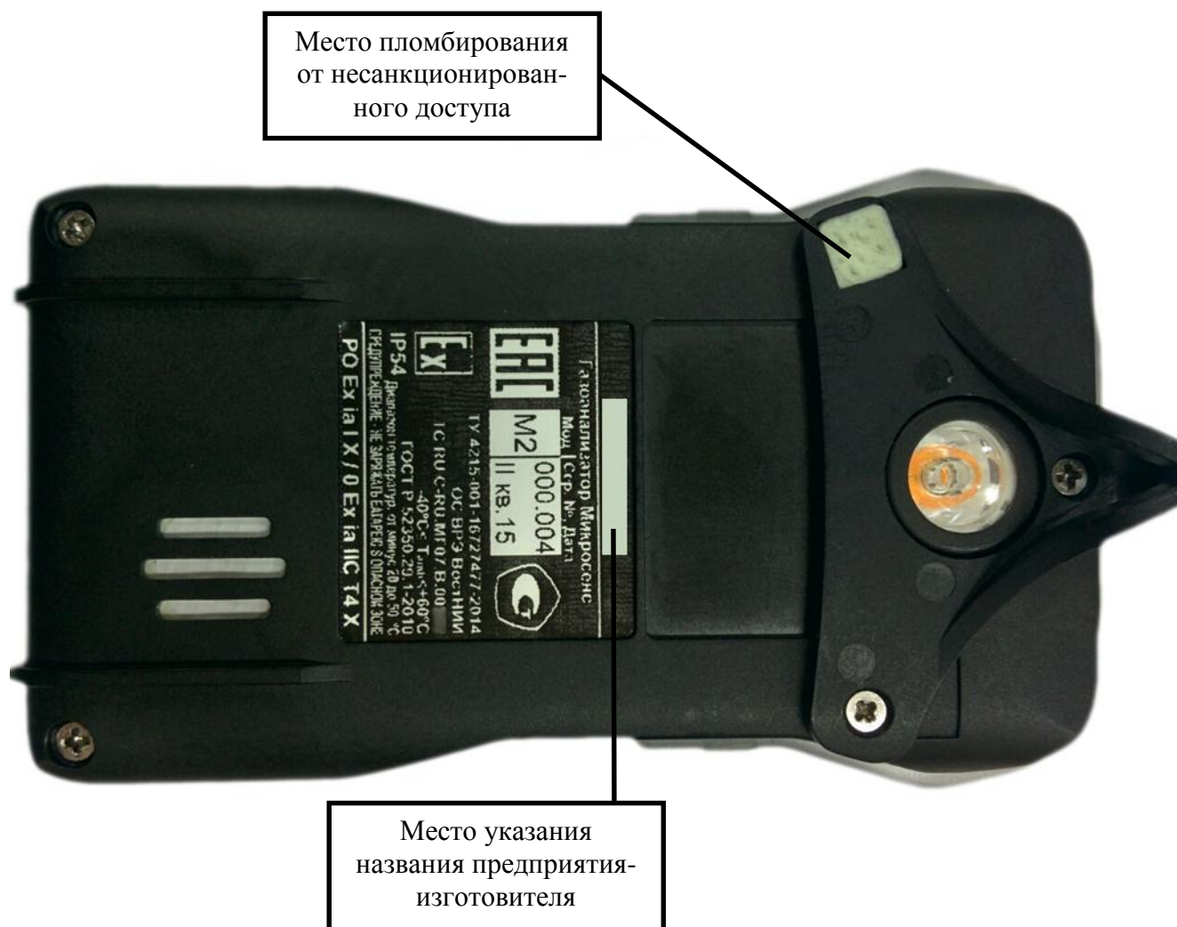
Рисунок 2 - Схема пломбировки от несанкционированного доступа
