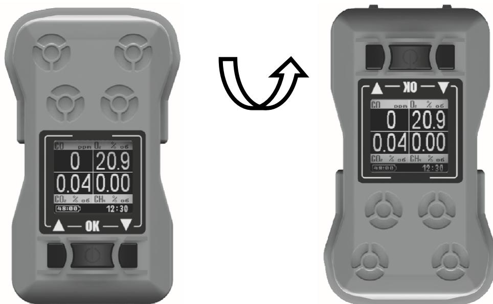
Рисунок 5. Автоматическая функция поворота изображения на дисплее
