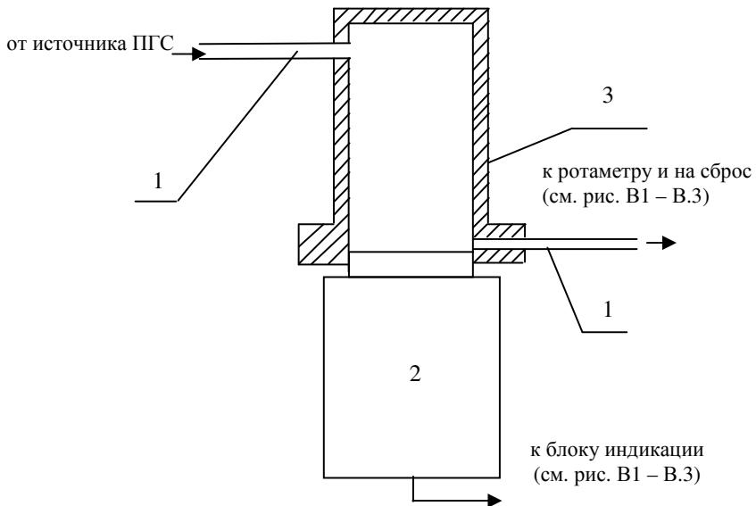
1 – соединительные трубы; 2 – блок датчиков; 3 – адаптер
