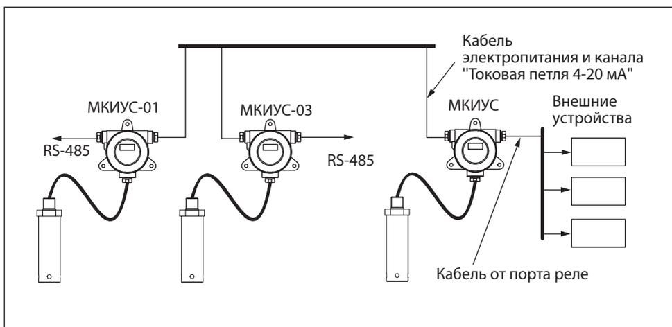
Рис.4. Схемы подключения ГС "Сенсон-СД-7031-СМ" к модулям МКИУС
