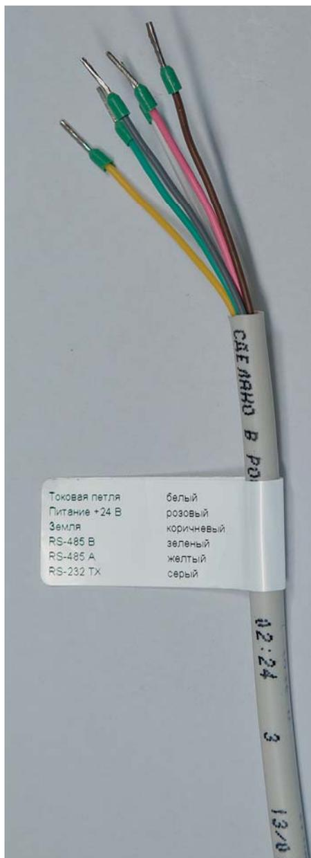
Рис.7. Цветовая маркировка кабеля
