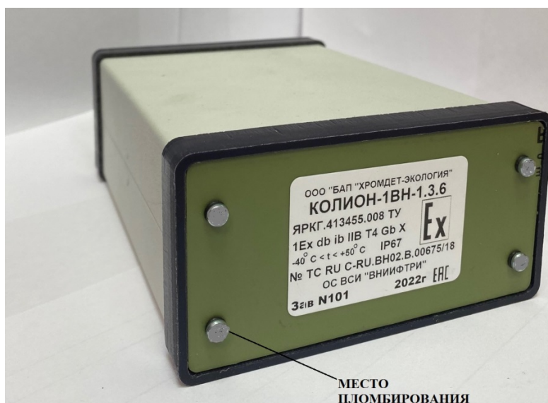
Рисунок 2 - Общий вид задней панели газоанализаторов переносных КОЛИОН-1ВН с шильдиком и место пломбирования от несанкционированного доступа
