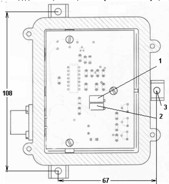
**Рис.3.Датчик СИГМА-03.ДК со снятой крышкой. 1- регулировка нулевого сигнала, 2- регулировка усиления, 3 - присоединительное отверстие диаметром 4.5 мм.**
