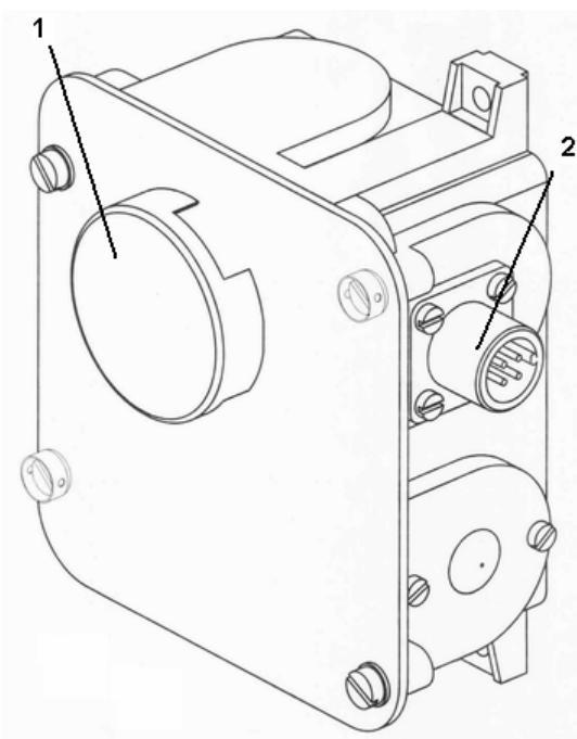
**Рис.2. Внешний вид датчика, 1- защитная крышка сенсора, 2-розетка.**
