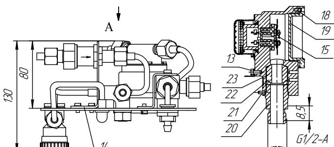
Рисунок В.3 - Датчик под пайку кабеля
