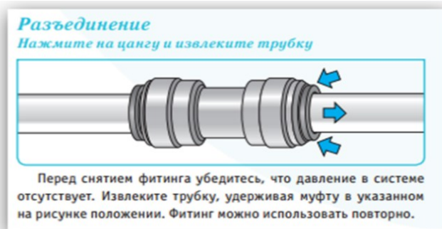
Рисунок 3 – Разъединение трубок от термостата
