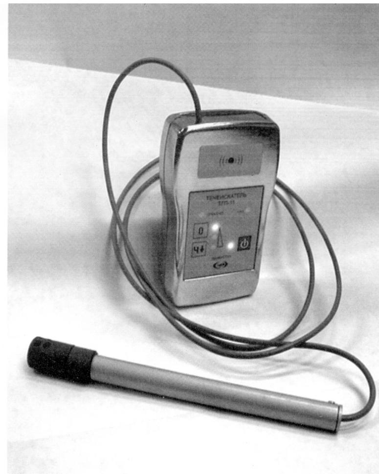
Рисунок А.1 – Общий вид течеискателя
